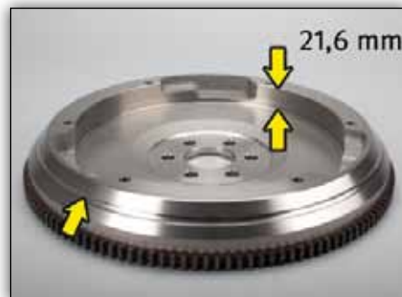
Slika 2: Št. originalnega dela 93186460/5616016 z zarezo na obodu je globina vztrajnika 21,6 mm
