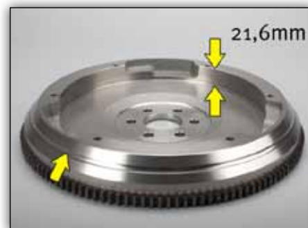
Slika 2: OE broj 93186460/5616016 sa obodnim udubljenjem, dubina zamašnjaka je 21,6 mm
