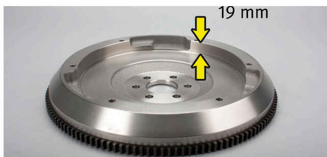
Снимка 1: OE номер 90536140/616169 без отстъп по периферията, дълбочина на маховика 19 мм
