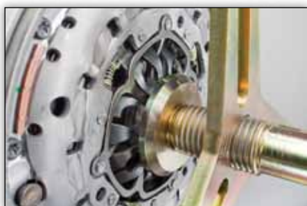
Slika 8: Popustite membransko vzmet tako, da zrahljate vreteno orodja za montažo sklopke SAC ter ga s pomočjo stebelnih vijakov odstranite
