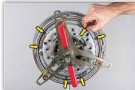
Slika 7: Priložene vijake ročno vstavite v 6 razpoložljivih lukenj z navoji ter jih privijte z momentom privijanja 10,5 \pm 1 Nm
