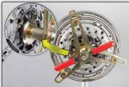
Slika 6: Namestite orodje za montažo sklopke SAC ter zategnite tlačno ploščo tako, da se prirobnica pokrova nasloni na dvomasni vztrajnik LuK DMF
