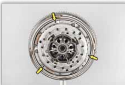
Slika 9: Ročno vstavite še preostale 3 vijake ter jih privijte z momentom privijanja 10,5 \pm 1 Nm
