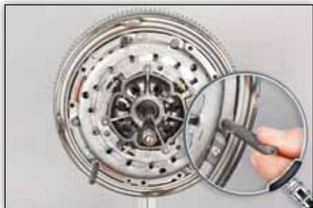
Slika 5: Ročno sukajte stebelne vijake na orodju za montažo sklopke SAC dokler ne začutite rahlega upora; ne uporabljajte nobenega orodja
