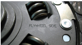
איור 4: התקנה לא נכונה
