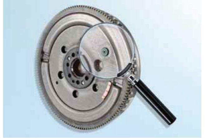
Sekil 1: DMF'de taşıma emniyet pimi motor ilk çalıştırıldığında iki parçaya ayrılır.
