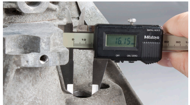
Зображення 2: Якщо діаметр отвору є меншим, ніж 21 мм, отвір необхідно розсвердлити принаймні до діаметра 21 мм або максимум до 24 мм
