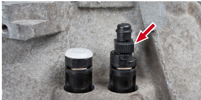
Fig. 8: Purjorul poate fi acționat cu mâna sau cu o cheie
