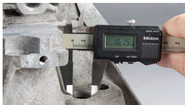
Fig.2: În cazul în care diametrul este mai mic de 21 mm, acesta trebuie mărit cel puțin la această dimensiune, dar nu mai mult de 24 mm
