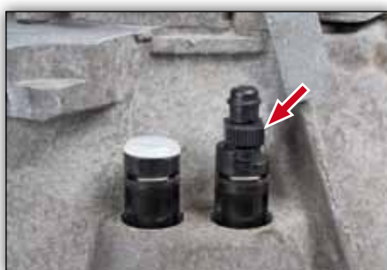
Slika 8: Odzračni ventil se može otvoriti ručno ili primjenom ključa (13 mm)
