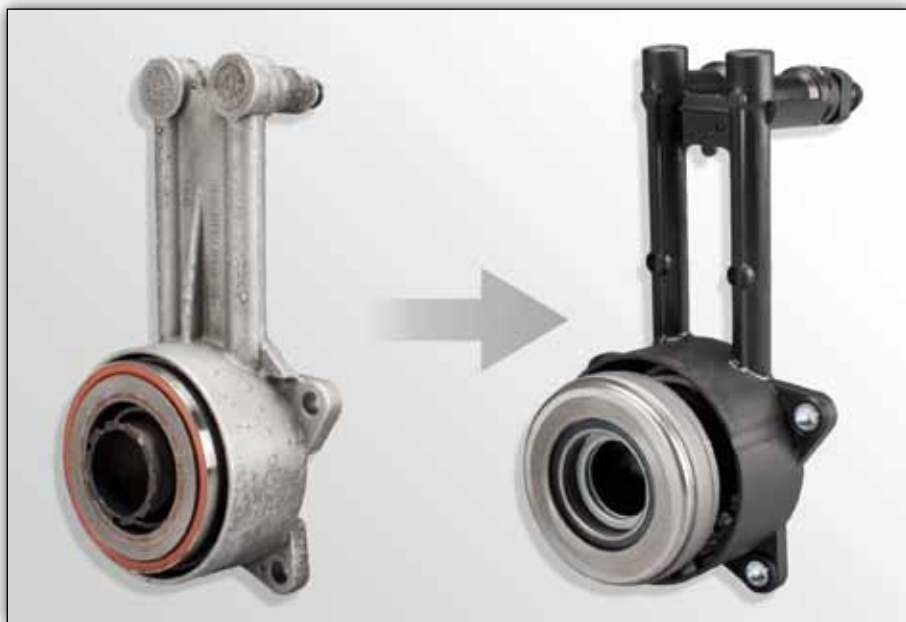
Slika 1: Zamjena metalne izvedbe kućišta plastičnim
