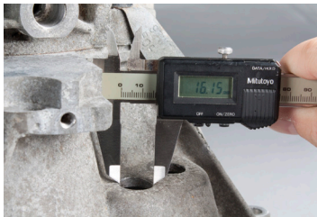
איור 2: במידה והקוטר קטן מ- 21 מ"מ, חובה להגדילו לפחות ל- 21 מ"מ עם הגבלת קוטר מקסימום של 24 מ"מ.
