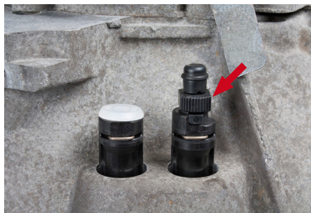
איור 8: פיטמת הניקוז ניתנת להפעלה באמצעות כח יד או באמצעות מפתח פתוח (13 מ"מ)
