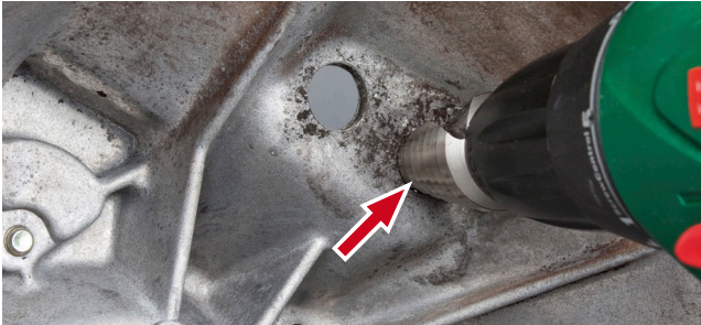
Billede 5: Boring af hul
