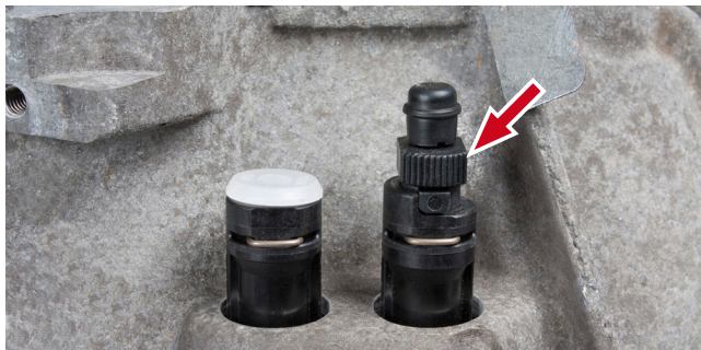
Billede 8: Udluftningsdyse kan styres manuelt eller med svensknøglen (13 mm)
