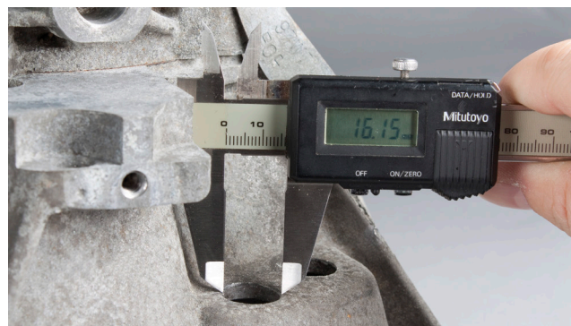
Billede 2: Er diameteren mindre end 21 mm, skal man bore den til min. 21 mm, maks. 24 mm
