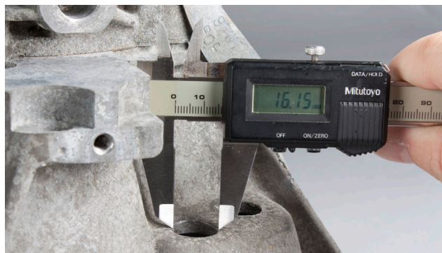
Снимка 2: Ако диаметърът е по-малък от 21 мм, той ще трябва да се увеличи на размер до 21 мм, или до максимум 24 мм
