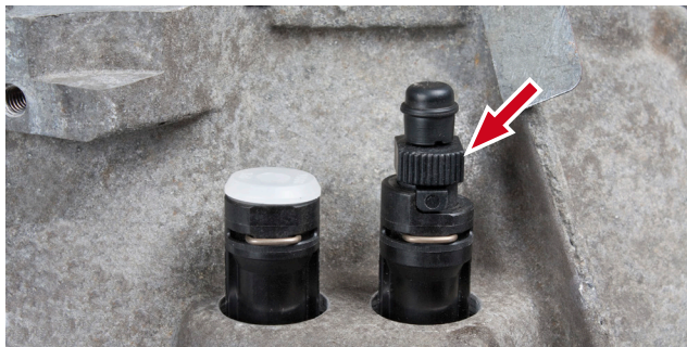
Снимка 8: Обезвъздушаващият нипел може да се задейства на ръка или с помощта на ключ (SW 13)
