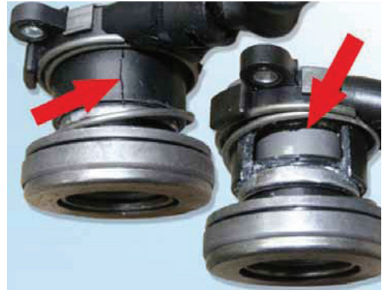
Sekil 5: CSC yanlış montaj sonucu zarar görür.
