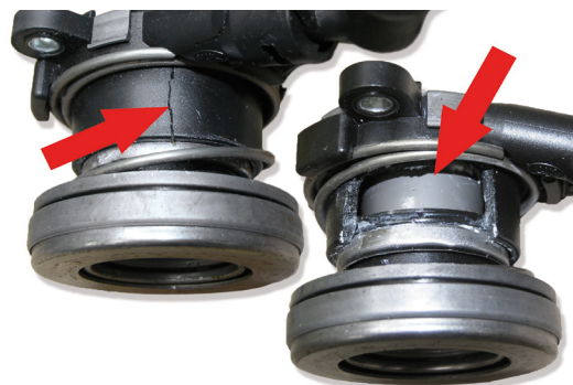
Bild 5: Slavcylindern förstörd genom felaktig montering
