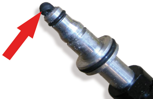
Bild 4: Om den gamla tätningsseringen inte tas bort, trycks den in i CSC och täpper till hydraulleddningen
