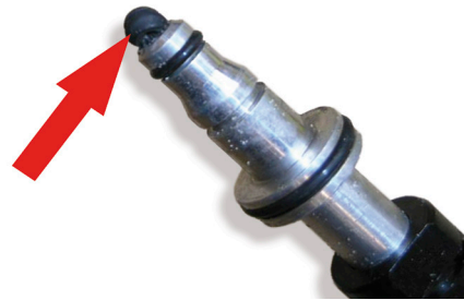
תמונה 4: מידה והאטם הישן לא הוסר, הוא עלול להידחף אל תוך המשאבה המשנית CSC ולחסום את הצנור.
