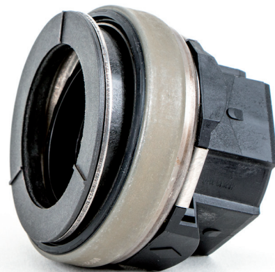
Fig. 1: Cojinete de desembrague con anillo de contacto de movimiento axial de plástico
