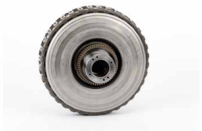
EMBRAGUE DOBLE, LADO DE LA CAJA DE CAMBIOS
