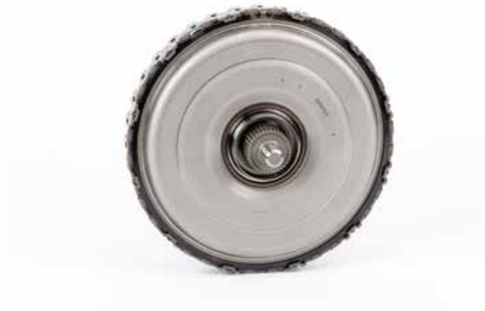
EMBRAGUE DOBLE, LADO DEL MOTOR
