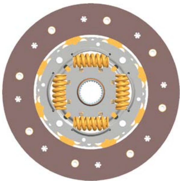
Disco frizione con smorzatori torsionali
