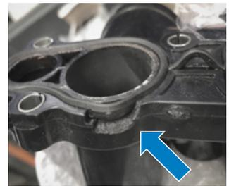
Fig. 3: Rottura (tipologia di danno)
