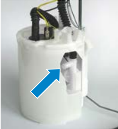
Şek. 1: Kör bağlantılı yakıt besleme modülüne bakış (kroki)
