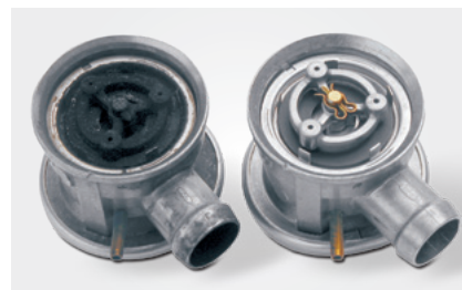
已打开的二次进气阀 左侧：由于尾气冷凝物受损 右侧：崭新状态
