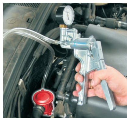
利用手动真空泵检查二次进气阀
