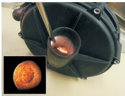
二次空气泵的进气口腐蚀内部
