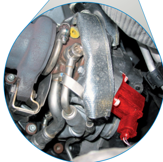
Återcirkulerande dumpventil i VW EOS TFSI (rödmarkerad)
