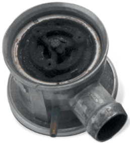
Egzoz gazı yoğunluğundan kaynaklı hasar
