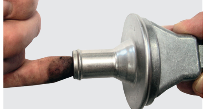
Şek. 1: Çekvalfin kolay kontrolü
