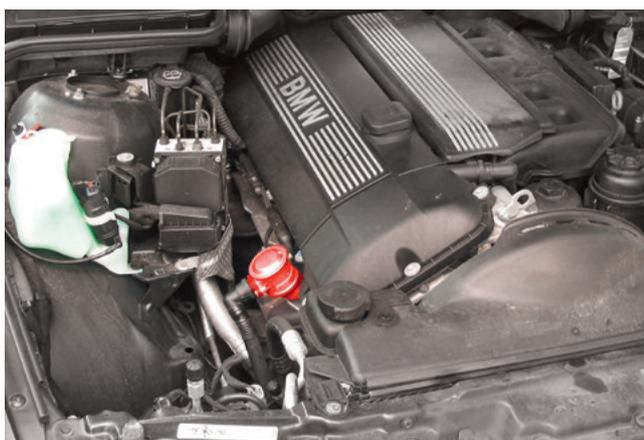
二次进气阀是二次进气系统的组成部分。它安装在二次空气泵 (01) 与排气歧管之间。它们防止排气系统中的压力峰值对二次进气系统造成损坏, 以及排气或冷凝物进入二次空气泵。
