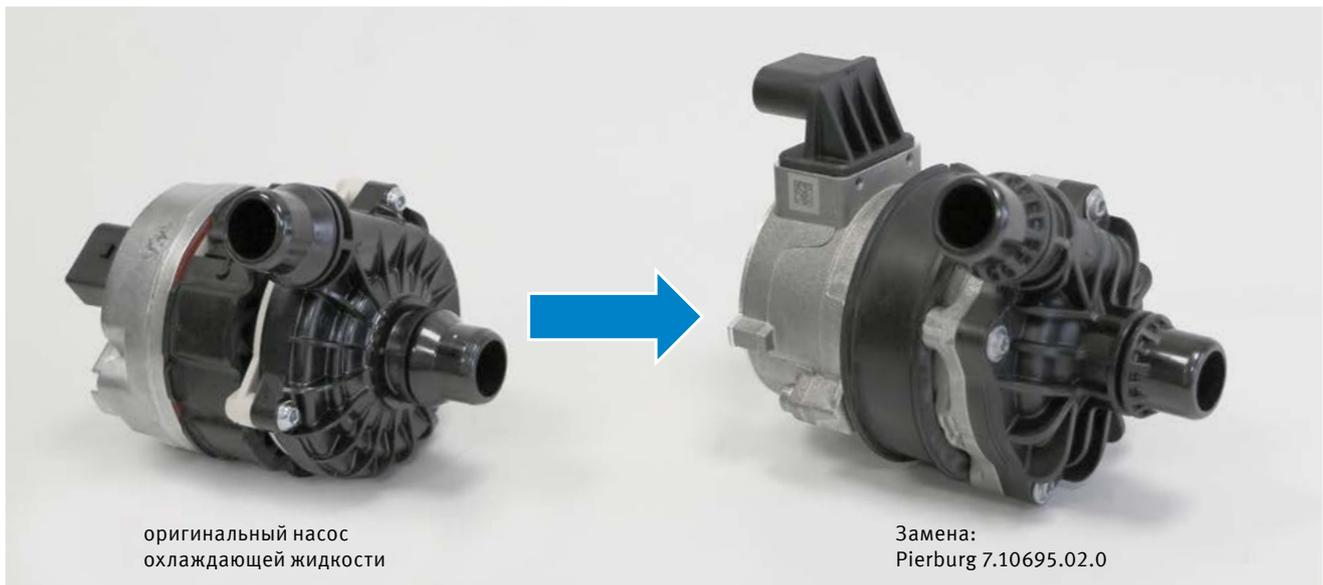
оригинальный насос охлаждающей жидкости
