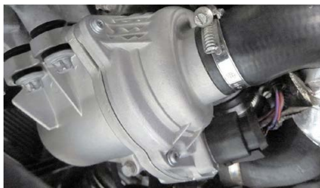
Pompe montée dans le véhicule
