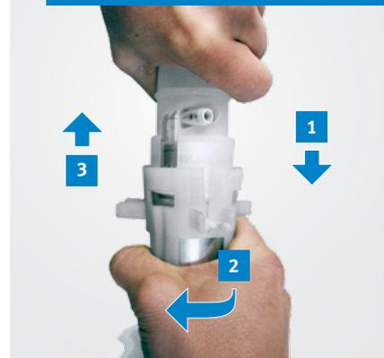
L'outil écarte les fixations qui maintiennent la pompe à carburant dans le module d'alimentation en carburant. Cette opération est particulièrement simple dans le cas des pompes à carburant avec tubulure de refoulement coudée.
