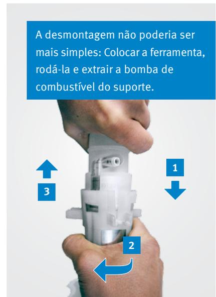
A ferramenta expande os suportes que fixam a bomba de combustível no módulo de alimentação de combustível. Nas bombas de combustível com conexão de pressão angulada, isso funciona extremamente bem.
