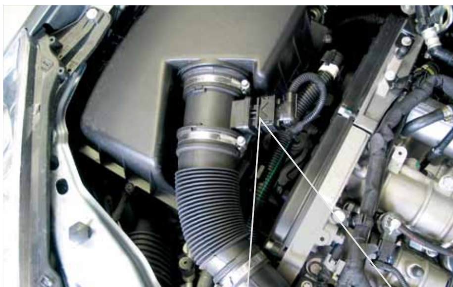
Przyspawany czujnik przepływu powietrza
