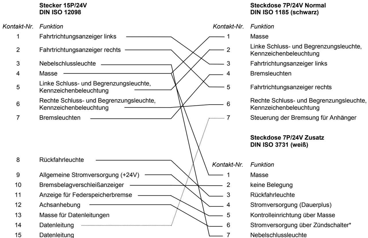
*Alle Leitungsquerschnitte 1,0mm<sup>2</sup>, außer Masseleitungen 1,5mm<sup>2</sup>*
